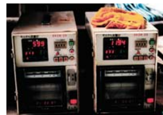
JETMS注入流量管理装置
